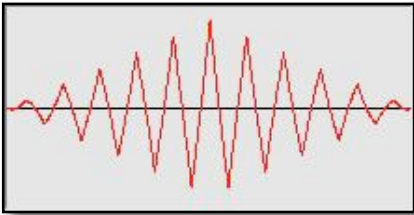
Sine: mod F2 using F1 (AM DSB, F_2=11 \times F_1 ).
