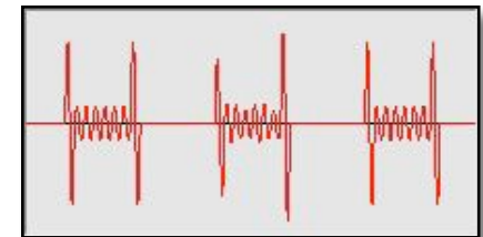
Sine H-Bomb: mod F2 with F1 (AM DSB, F_2=3 \times F_1 ).
