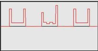
Square H-Bomb: mod F2 with F1 (AM SSB, F2=3 \times F1 ).
