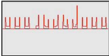
Triangle: mod F2 with F1 (AM SSB, F2=11 \times F1 ).
