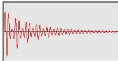
Damped sin: mod F2 with F1 (AM DSB, F_2=3 \times F_1 ).
