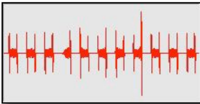
Square H-Bomb: mod F2 with F1 (AM DSB, F_2=11 \times F_1 ).
