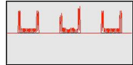
Sine H-Bomb: mod F2 with F1 (AM SSB, F2=3 \times F1 ).
