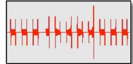
Sine H-Bomb: mod F2 w/ F1 (AM DSB, F_2=11 \times F_1 ).
